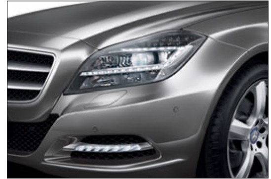
Scheinwerfer mit integriertem Infrarot-LED-Modul.
