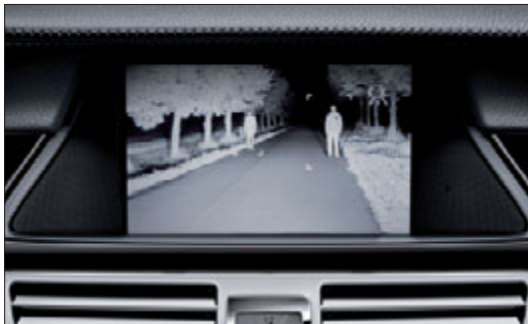
Der Nachtsicht-Assistent Plus zeigt den Fernlichtbereich als Bild im Zentraldisplay.
