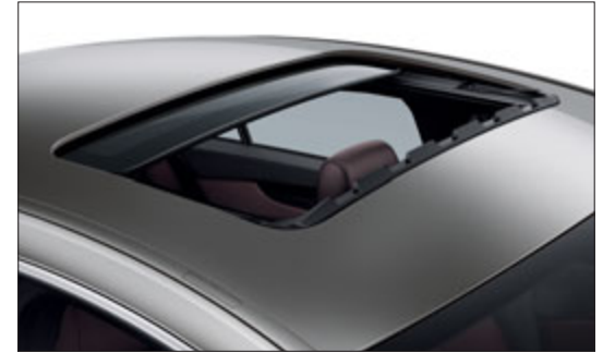
Das Schiebedach in Glasausführung mit Sommeröffnungsfunktion per Fernbedienung.
