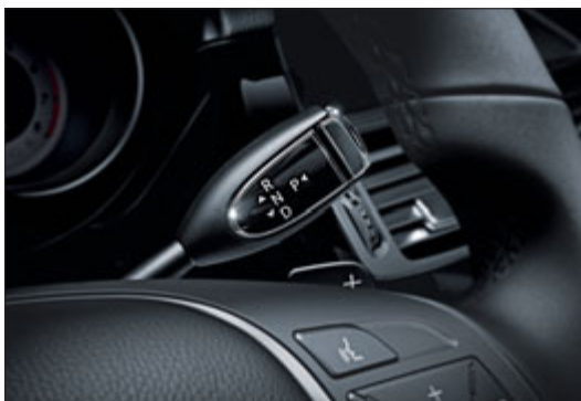
DIRECT SELECT-Wählhebel am Lenkrad und Schaltpaddles.
