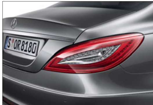
LED-Heckleuchte, um das Heck des Fahrzeugs gezogen.
