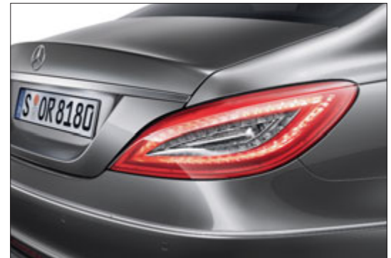
Heckleuchte in LED-Technik, Bremslicht aktiv.
