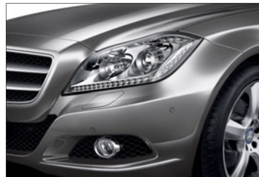
Bi-Xenon-Scheinwerfer mit integrierter LED-Technik.
