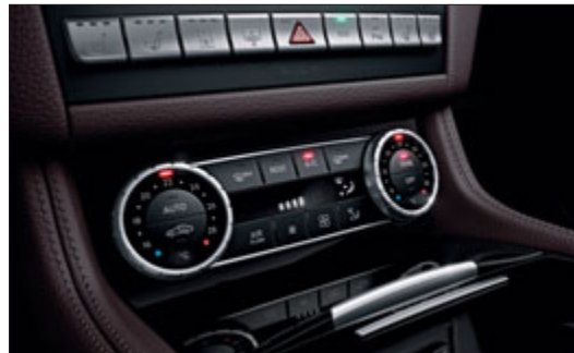
Über die Klimatisierungsautomatik THERMOTRONIC kann das Raumklima in drei Zonen individuell reguliert werden.
